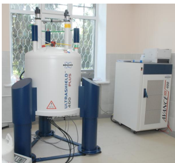
Fig.1. Spectrometru Rezonanță Magnetică Nucleară 400 MHz (RMN 400) Anul producerii: 2008 Anul procurării: 2009
