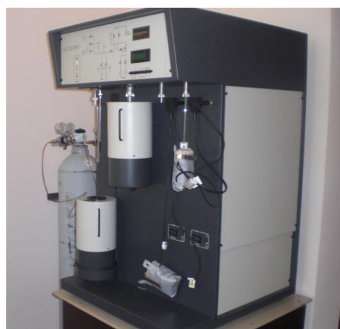
Fig.5. Sistem pentru determinarea suprafeței specifice și volumului porilor materialelor Autosorb-1 Anul producerii: 2008 Anul procurării: 2009
