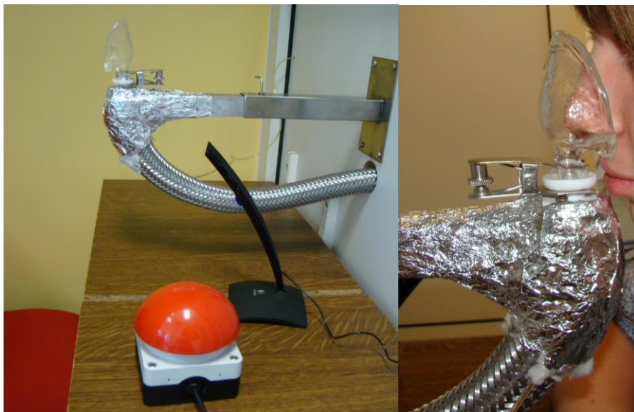
Fig. 2.3. Port-sniffing (cu mulajul nasului), buton și microfon pentru înregistrare
