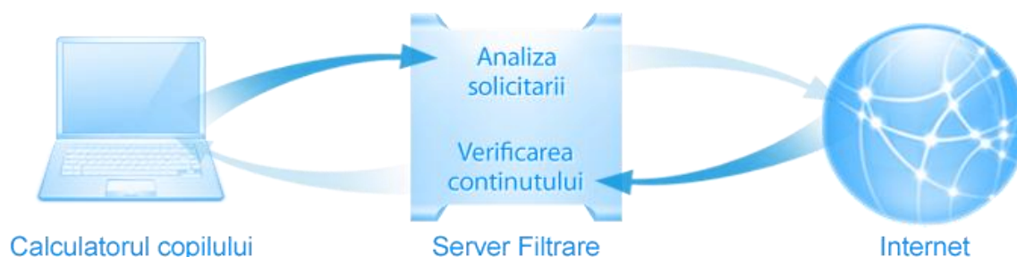
Fig. 2.9. Principiul de lucru al filtrului de protecție on-line Robokid (sursa www.robokid.ro )
