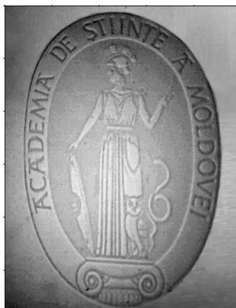
Рис. 4.16. Поточечный рисунок, записанный электронным пучком на тонкой пленке состава As-S-Se-Sn с помощью программного обеспечения.
