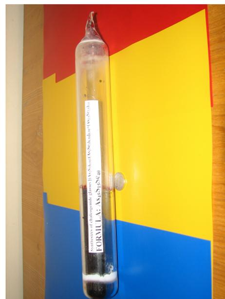
Рис.2.2. Фотография кварцевой ампулы с синтезированным халькогенидным стеклом  $As_4S_3Se_3$ .
