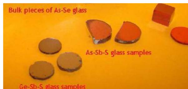
Рис.1.4. Полированные образцы в форме дисков некоторых халькогенидных стекол для измерений оптических и физических свойств.
