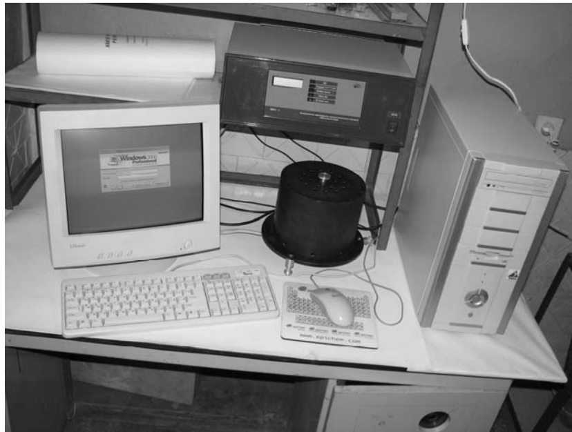
Fig. 2. Standul computerizat pentru controlul proprietăților electrofizice și gazosensibile ale nanopeliculelor.
