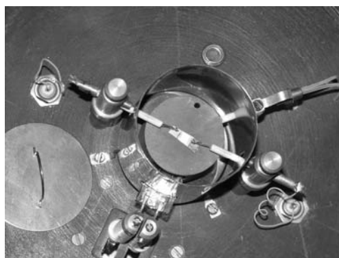
Fig. 1. Celula de măsură a instalației de control a proprietăților electrofizice și gazosensibile ale nanopeliculelor.
