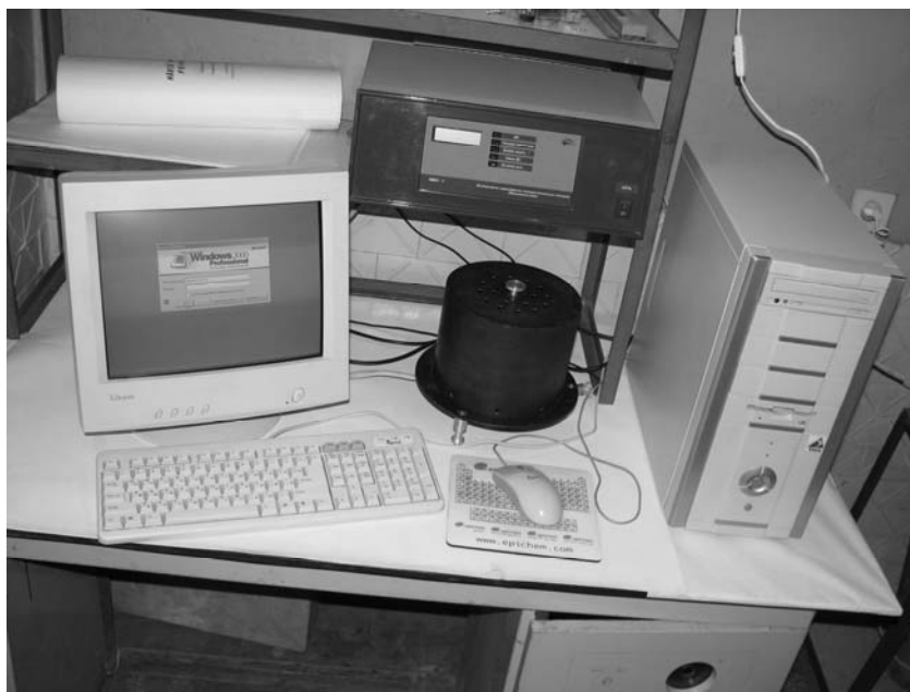
Рис. 2. Компьютеризированный стенд для контроля электрофизических и газочувствительных свойств наноплёнок.
