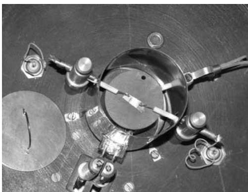
Рис. 1. Измерительная ячейка установки для контроля электрофизических и газочувствительных свойств наноплёнок.
