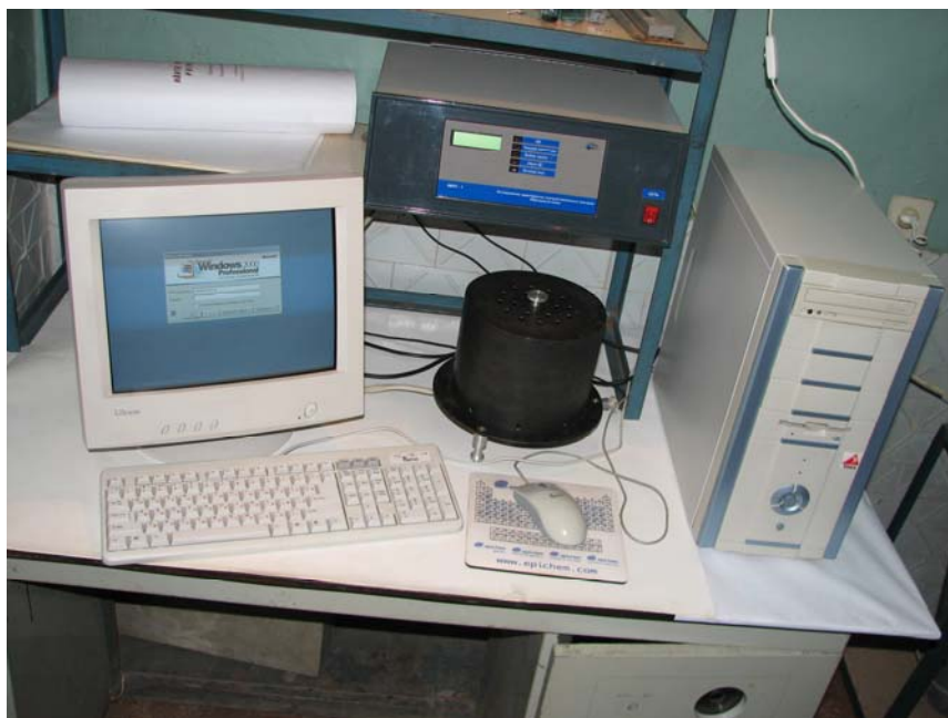
Рис. 2.9. Компьютеризированный стенд для контроля электрофизических и газочувствительных свойств наноплёнок.
