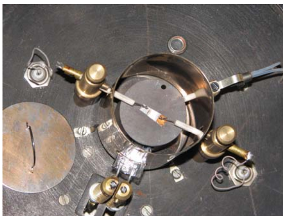
Рис. 2.8. Измерительная ячейка установки для контроля электрофизических и газочувствительных свойств наноплёнок.
