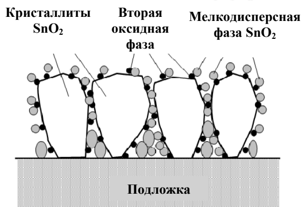
Рис. 4.6. Схематическая диаграмма структуры легированных плёнок \text{SnO}_2 .
