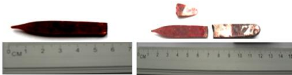
Fig.1. Mostre de eșantioane obținute prin despicierea monocristalelor primare.
