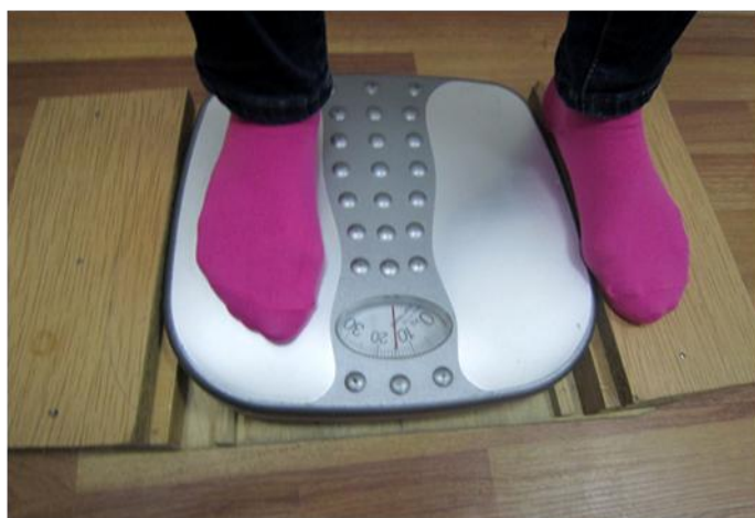
Fig. 4.7. Cântarul încorporat într-un suport pentru măsurarea gradului de sprijin al membrelor pelvine.
