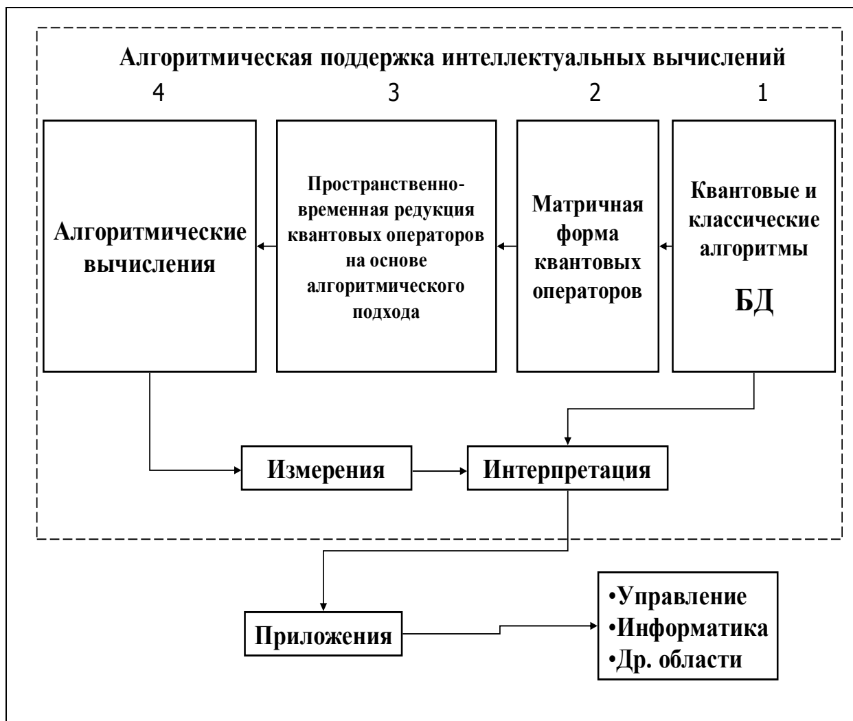
Рис. 1.6. Структура алгоритмической поддержки интеллектуальных вычислений
