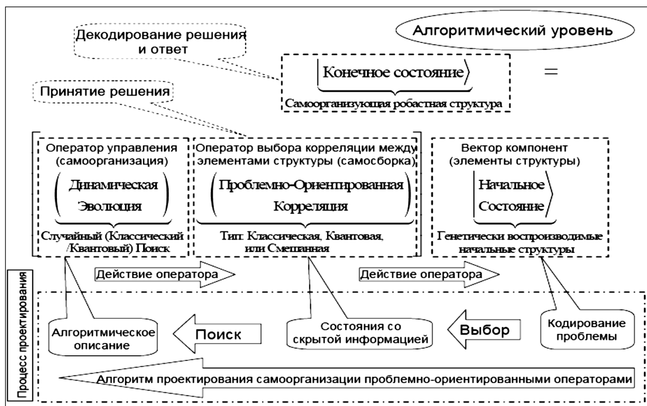
Рис. 2.8. Структура и функциональные связи квантового алгоритма управления самоорганизацией
