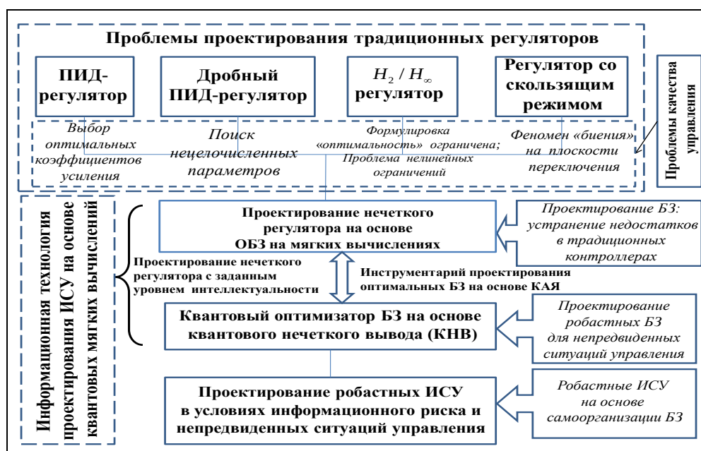
Рис. 1.3. Структура реализации информационной технологии проектирования робастных интеллектуальных регуляторов
