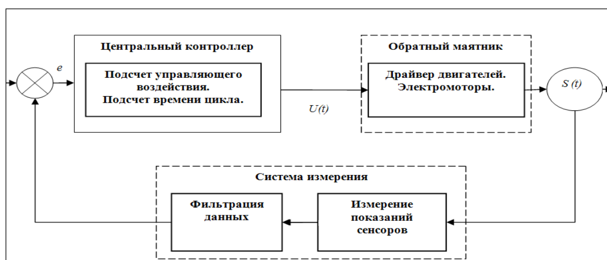
Рис. 3.6. Алгоритм программы микроконтроллера
