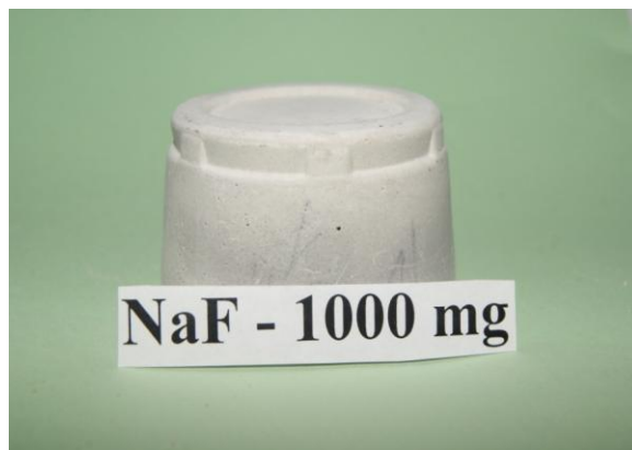
Fig. 4.9. Mostre de beton cu adaos de 1000 mg NaF la 100 g beton.
