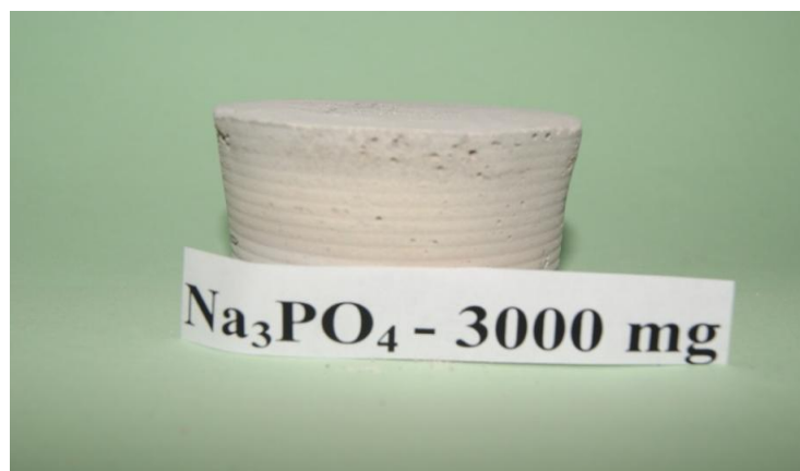
Fig. 4.27. Mostră de beton cu adaos de 3000 mg \text{Na}_3\text{PO}_4 la 100 g beton.
