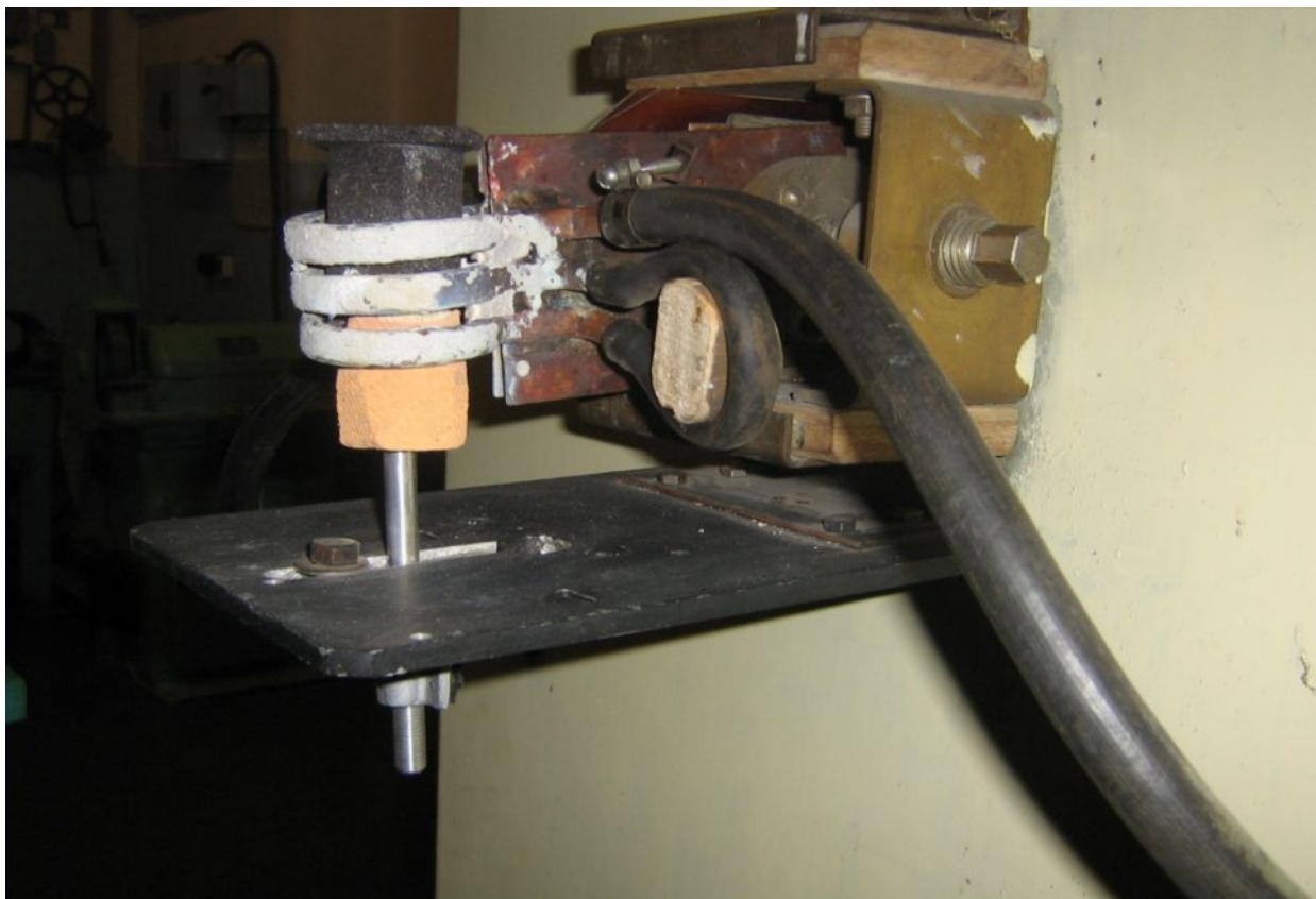
Рис 2.4 Индуктор высокочастотной установки ВЧИ-10У с тиглем для плавки алюминиевых сплавов
