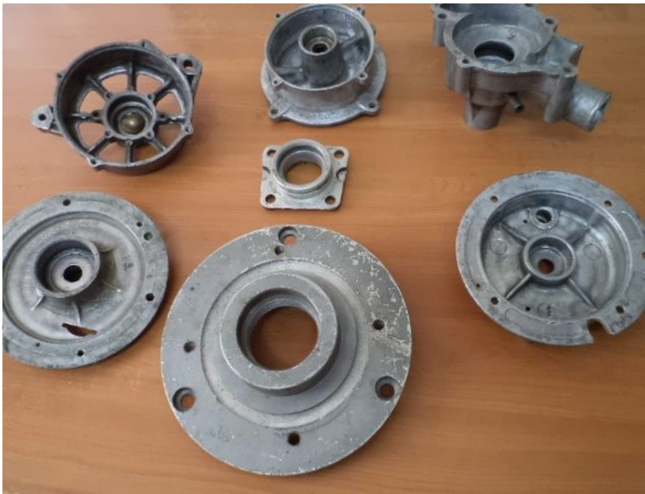
Рис 5.2 Детали, восстановленные с помощью электроискрового легирования.
