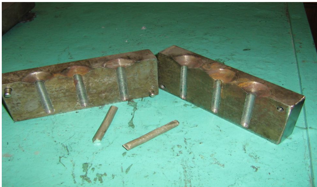
Рис 2.5. Кокиль для отливки обрабатывающих электродов из алюминиевого сплава.
