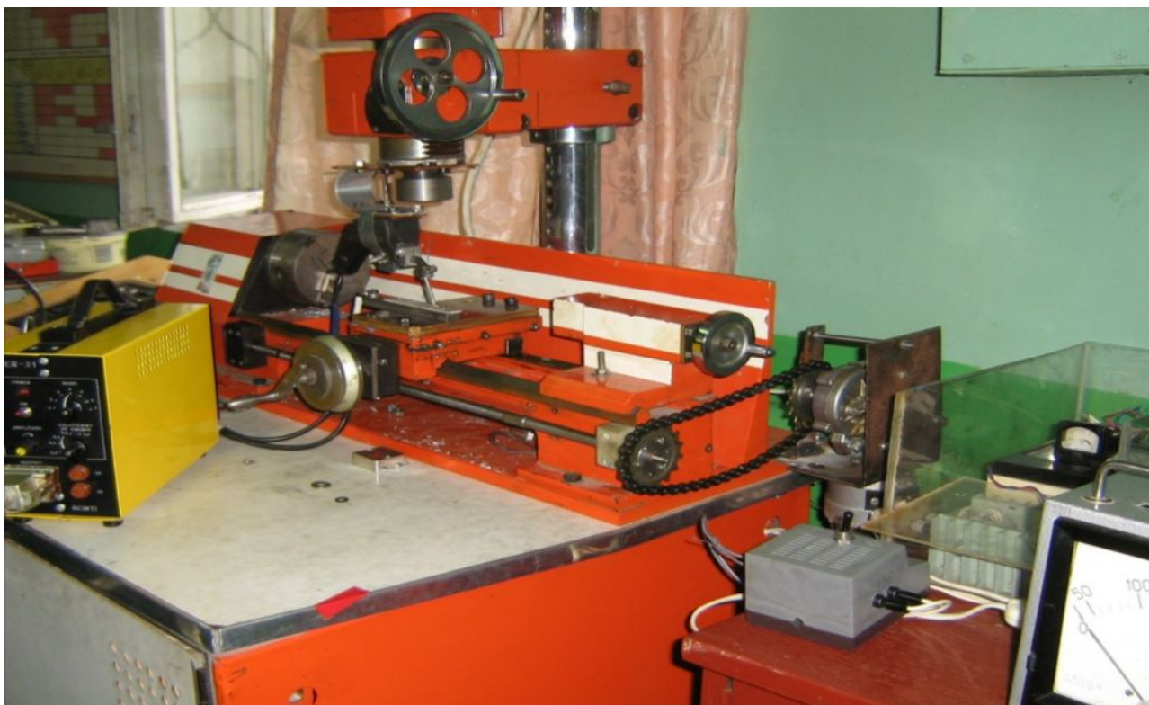
Рис 2.3. Экспериментальная установка электроискрового легирования для механизированного формирования покрытий.
