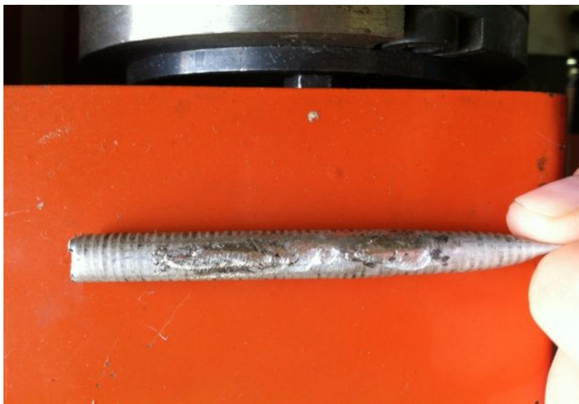
Рисунок 5.6. Трубка радиатора прошедшая обработку электроискровым легированием и пайку припоем ПОС40.
