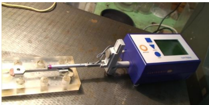
Рис.2.7.Измерение шероховатости образцов с помощью прибора Surtronic, Taylor Hobson.
