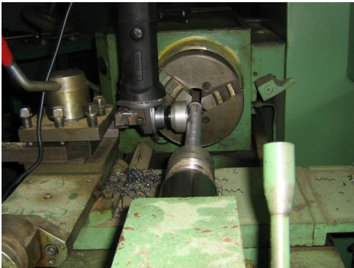
Рис. 5.8 Испытания абразивных свойств покрытия при шлифовке стального закаленного образца.
