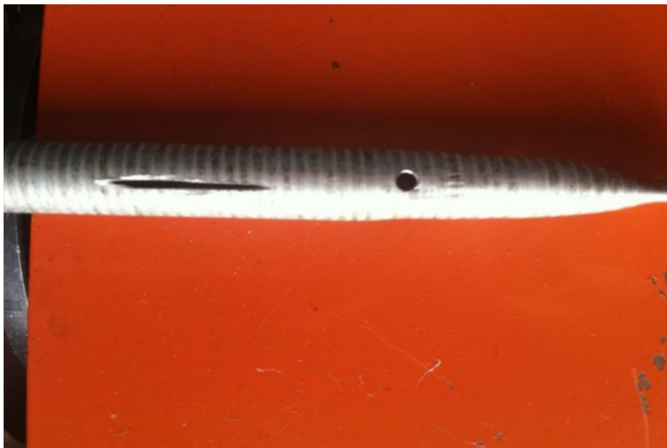
Рисунок 5.5. Трубка для запаивания с искусственно сделанными повреждениями .
