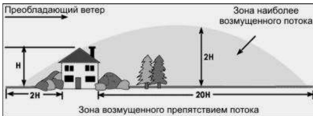
Рис. 1.11. Влияние препятствия на характер воздушного потока [44].
