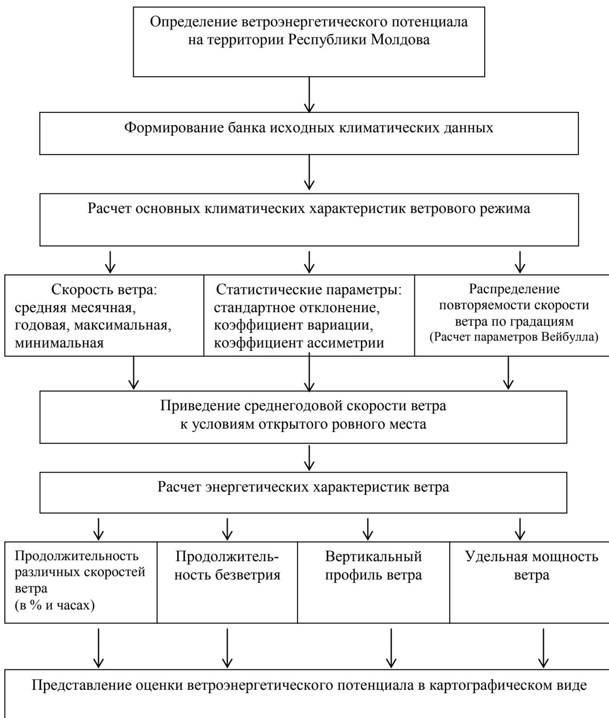
Рис. 4.1. Алгоритм определения ветроэнергетического потенциала
