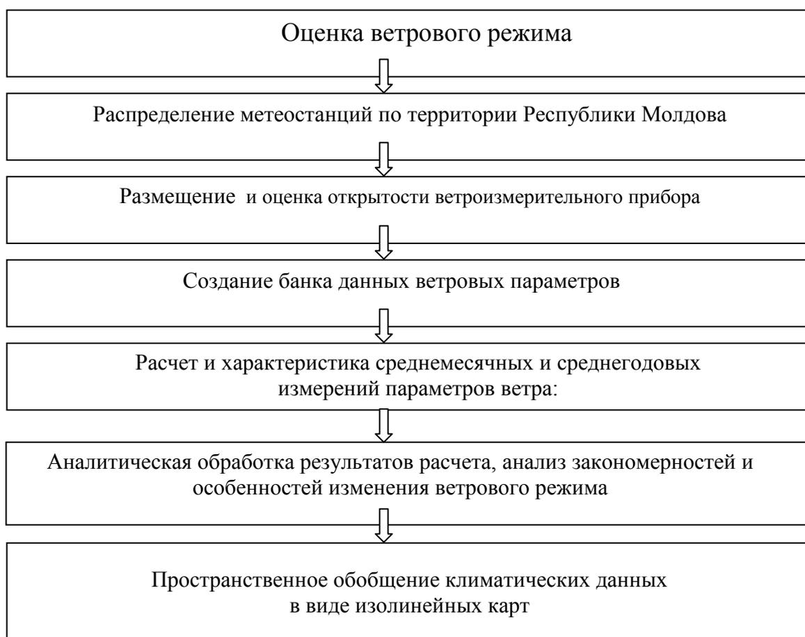
Рис. 2.1. Схема действий при оценке ветрового режима
