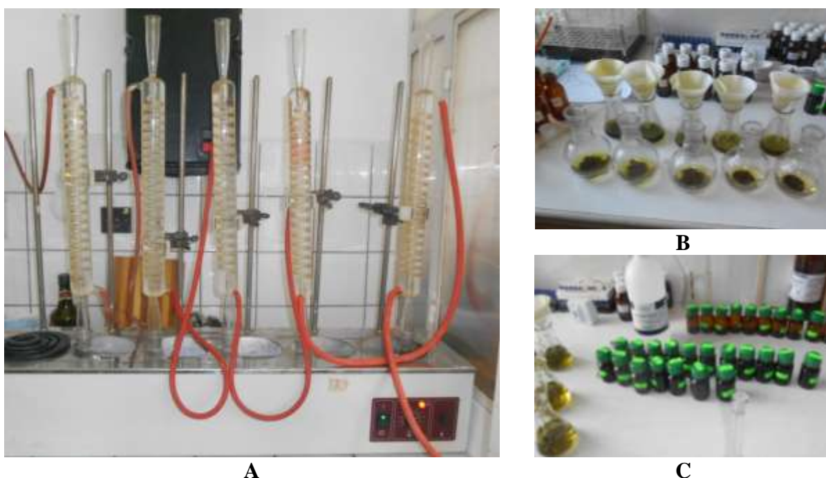
Fig. 2.1. Obținerea (A), filtrarea (B) și stocarea (C) extractelor de S. sclarea .
