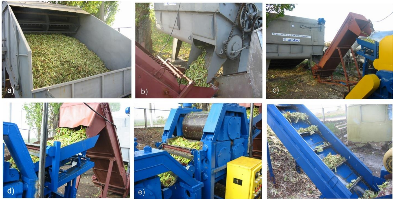
Figura 6.3. Secvențe din timpul încercării în condiții de exploatare(etapa II) a liniei tehnologice de stoarcere a sorgului zaharat: a) recepția tulpinilor fracționate; b) distribuirea; c) alimentarea; d) dozarea; e) stoarcerea sucului; f) – evacuarea bagasei.
