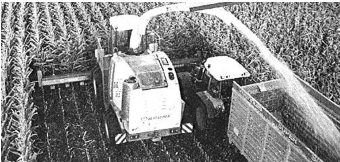
Figura 3.5. Combină de recoltat porumb pentru siloz (12 rânduri) (Krone, Germania)
