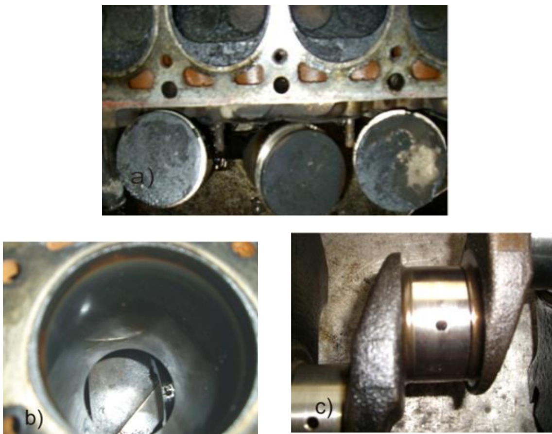
Figura 6.4. Aspectul suprafețelor de lucru ale pieselor din componența motoarelor VAZ, alimentate cu ecobenzine: a) chiulasa, b) cilindru-piston; c) arborele cotit
