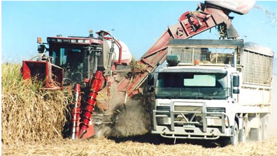
Figura 1.11. Combina modernă de recoltat sorg zaharat (trestia de zahăr)[producător- Case IH Austoft, Australia]
