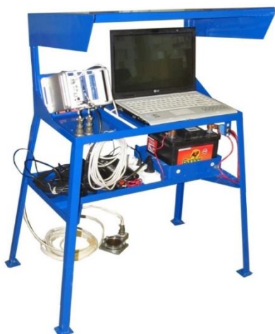
Figura 2.8. Test controller Q. Brixx gate cu moduli de măsurare Q.brixx a106, a107
