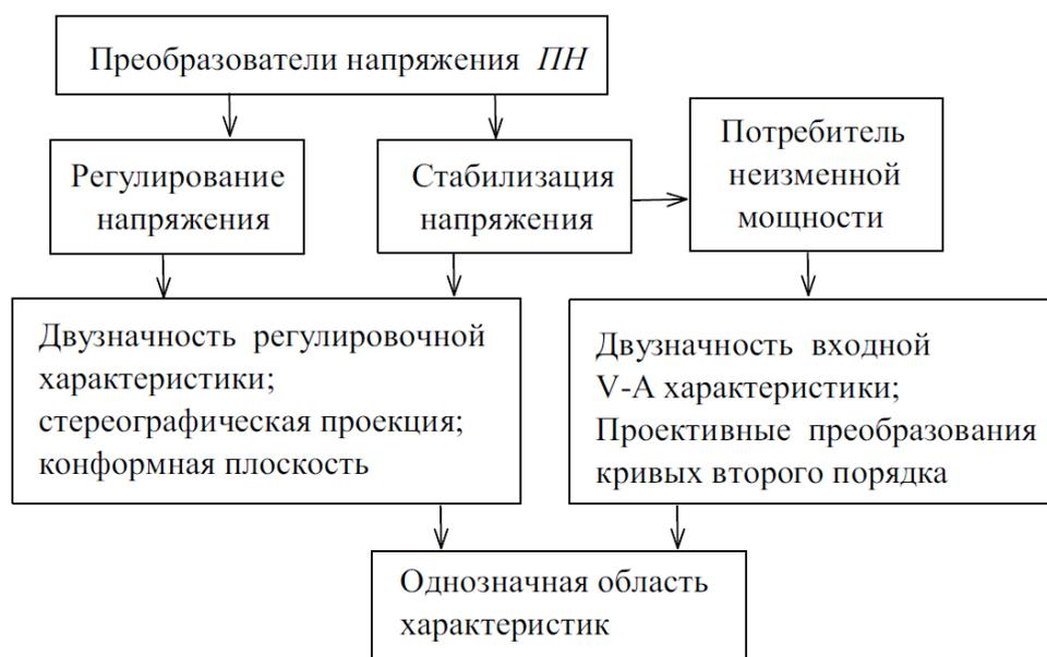
Рис.2.17. Виды цепей с *ПН* и содержание геометрической интерпретации.
