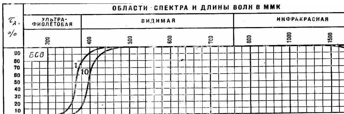
Fig. 2. 9. Filtru transparent, marca БС-8, grosimea sticlei 1 mm [129].
