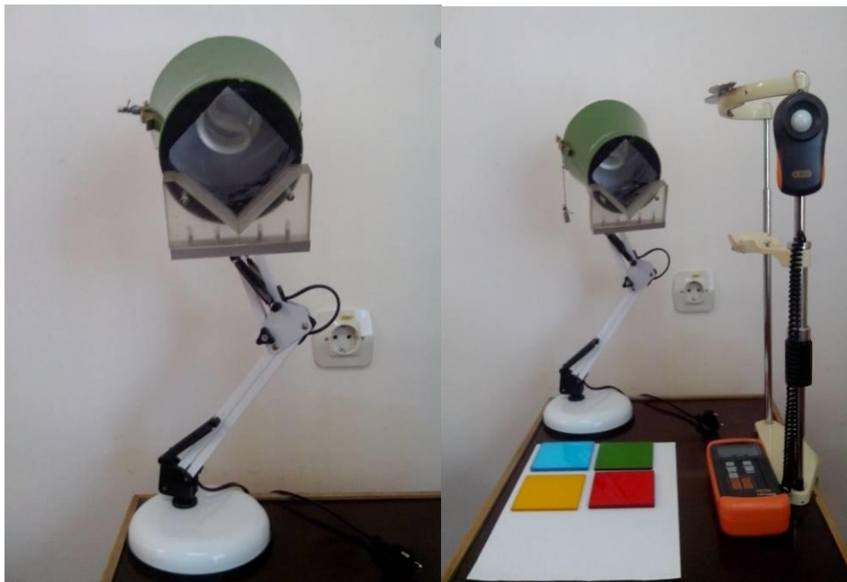
Fig. 2. 6. Lampă de masă cu stativ improvizat (stînga) și filtre spectrale (dreapta).
