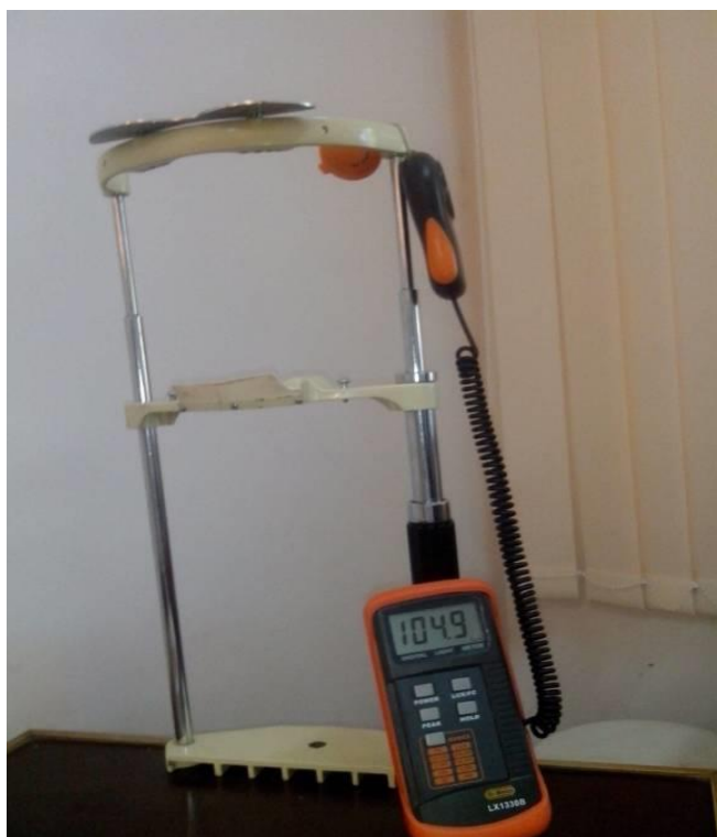
Fig. 2. 4. Stativ pentru a fixa fruntea și bărbia cu luxmetru.
