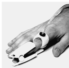
Fig. Schema sensorului fotopletismografic și modul lui de aplicare la fotopletismografia digitală
