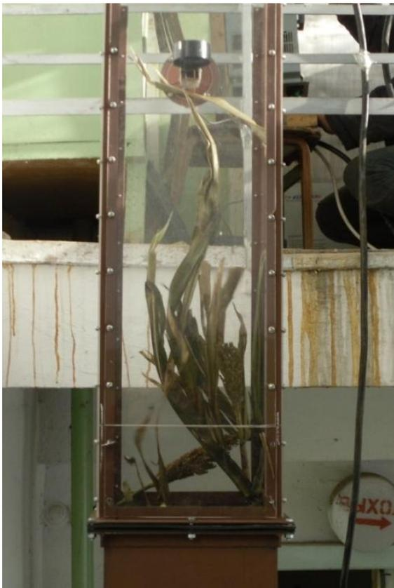
Рис. 3.10. Начало витания листьев в стволе включённой установки. Скорость воздуха – 9 м/с
