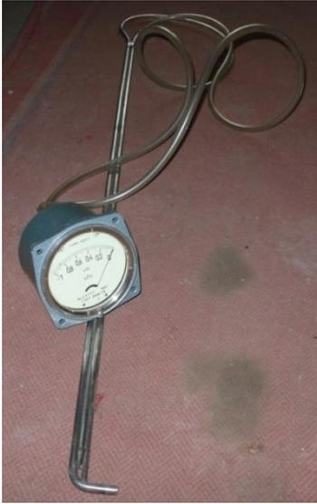
Рис. 3.7. Трубка Пито с микроманометром
