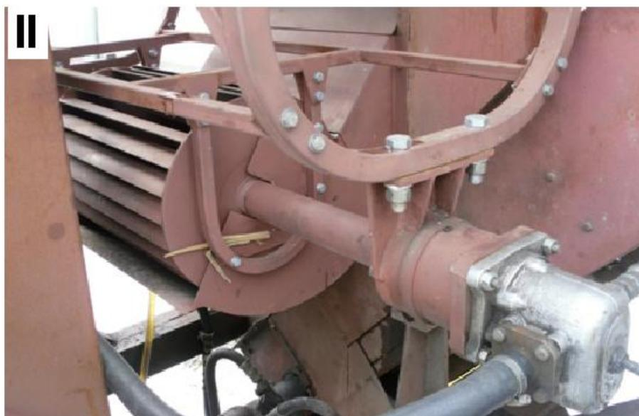
Рис. 3.6. I – схема диаметального вентилятора (расположение на комбайне аналогично показанному на рис. 3.8): 1 – диск; 2 – лопатка; 3 – кожух; II -- диаметальный вентилятор на комбайне
