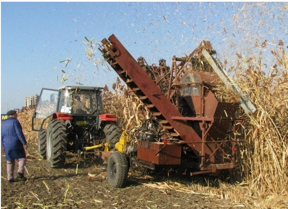
Рис. 4.18. Комбайн для уборки сахарного сорго на испытаниях
