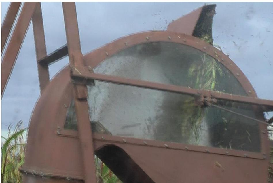
Рис. 2.24. Работа шторки для погашения кинетической энергии листостебельной массы, подаваемой измельчающим барабаном
