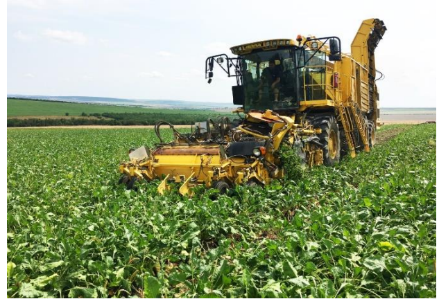
Рисунок П 2.8 Уборка сахарной свёклы самоходным 6-ти рядным комбайном типа “ROPA”
