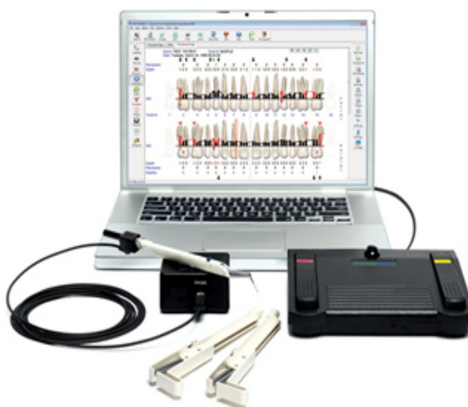
Fig. 2.8 Sonda parodontală de generația III-a, Florida Probe System, Gainesville, Florida, USA.
