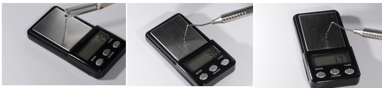
Fig. 2.7 (a) Aprecierea forței de sondare în grame a sondei automatizate, (b) a sondei convenționale CPITN la forță minimă de aplicare și (c) aplicarea forței maxime pe vârful sondei.
