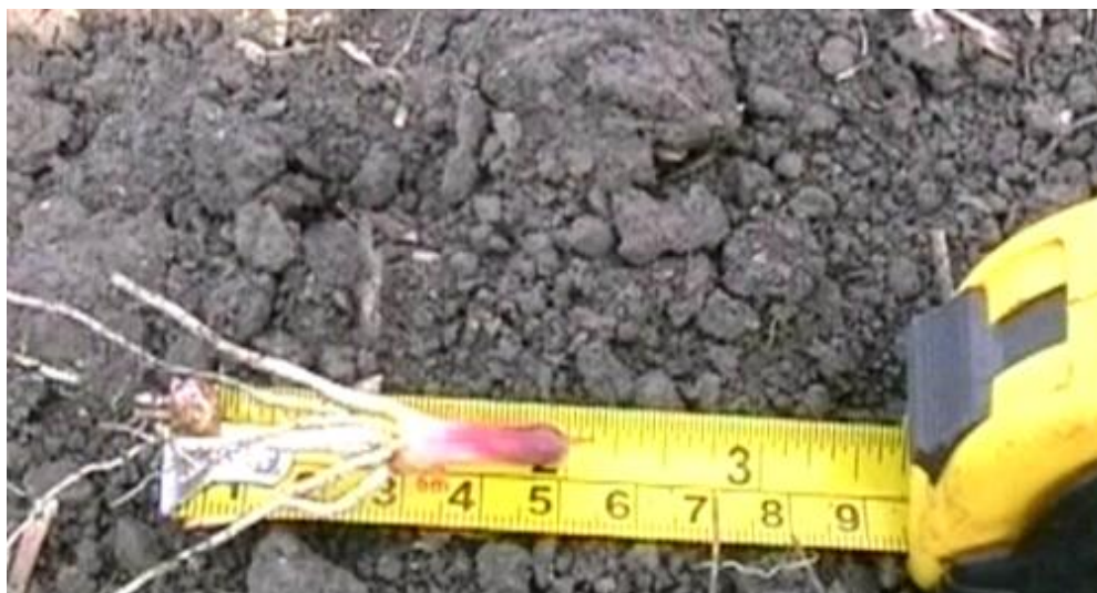
Fig. 3.12. Măsurări a adâncimii de încorporare a semințelor.
