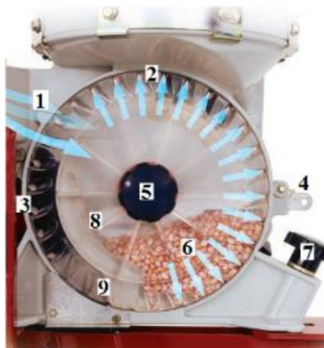
Fig. 1.7 Aparatul de distribuție a mașinii de semănat „Challenger”
