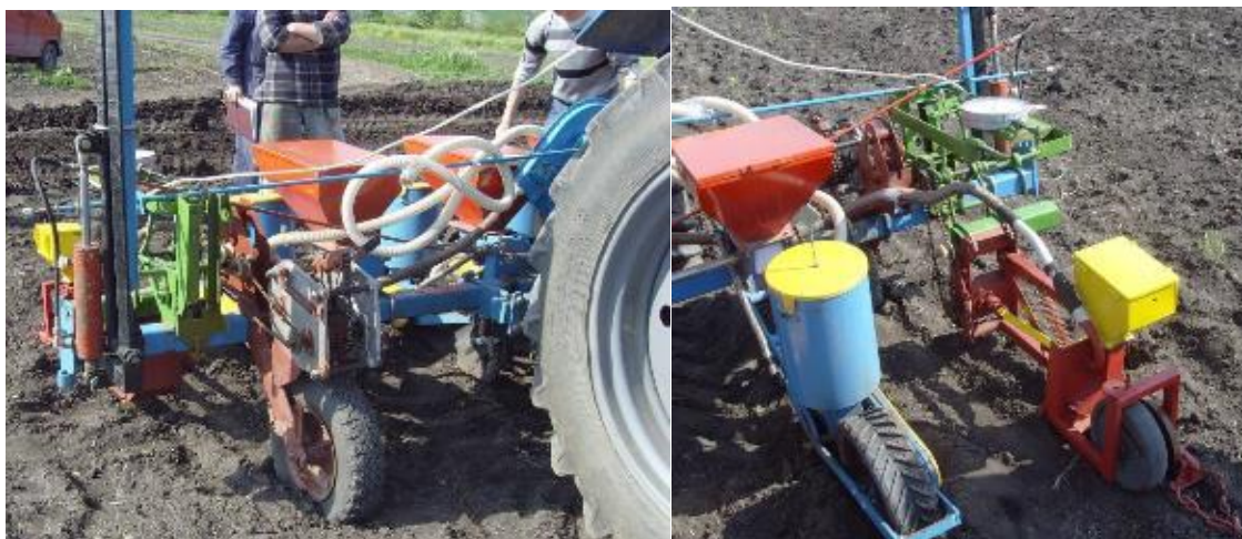
Fig. 3.9. Secția experimentală a semănătorii de precizie pentru culturi prășitoare
