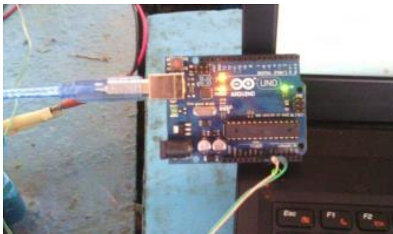
Fig. 3.5. Dispozitiv de transformare a semnalului de la amplificator la calculator
