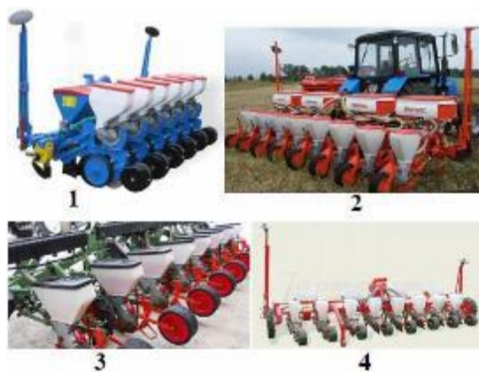
Fig. 1.2 Vederile semănătoarelor ce folosesc aparate de distribuție pneumatice cu agentul de lucru „vid”.
