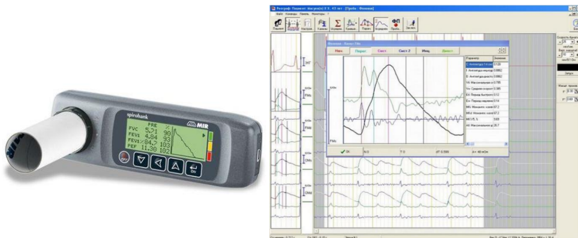
Fig. 2.2. Aparatul de spirometrie Spirobank, producător: MIR (stânga). Imaginea datelor spirometrice înregistrate (dreapta).
