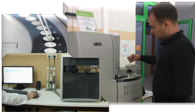
Figura 1 Aspecte la realizarea analizei chimice a probelor examinate la analizorul elemental Vario MACRO Cube CHNS&Cl (LBCS) și la analizorul LECO (Laboratorul de încercări a Centrului de Biomasă pentru Energie din Portugalia)
