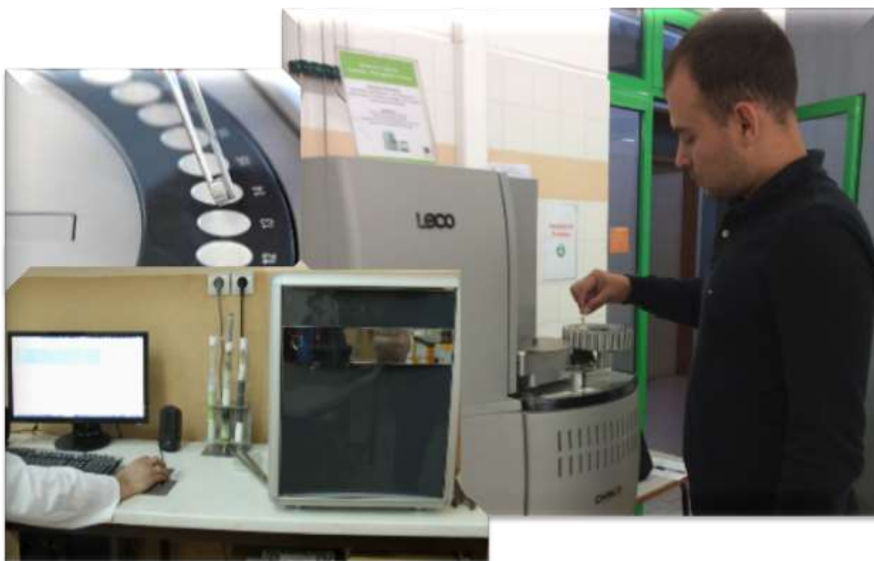
Figura 2.8. Aspecte la realizarea analizei chimice a probelor examinate la analizorul elemental Vario MACRO Cube CHNS&Cl (LBCS) și la analizorul LECO (Laboratorul de încercări a Centrului de Biomasă pt. Energie din Portugalia)
