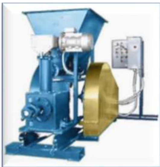
4.24. Presa de brichetare ПБУ-060-400 folosită la producerea biobrichetelor la SRL SRL Brilanprim
