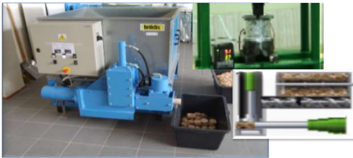
Figura 2.4. Instalațiile folosite la densificarea biobrichetelor experimentale de densificare: a) presa Brikles; b) presa pentru densificare singulară
