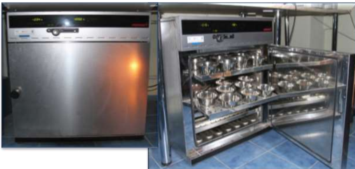
Figura 2.6. Secvențe din timpul determinării conținutului de umiditate prin cântărire la balanța analitică AS 220/C/2, RADVAG și uscare în etuva UNB 500 – Memmert
