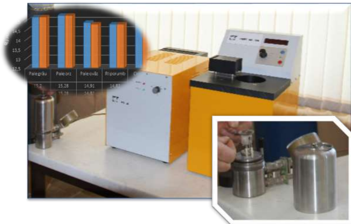
Figura 2.5. Analiza valorii calorifice superioare cu bomba calorimetrică LAGET MS – 10A
