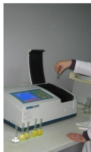
Figura A. 8.10. A – Soluțiile de rutozidă de diferite concentrații pentru construirea liniei etalon de rutozidă; B – măsurarea absorbanței la spectrofotometru.
