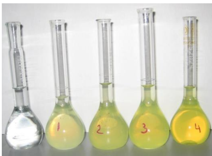
Figura A. 8.10. A – Soluțiile de rutozidă de diferite concentrații pentru construirea liniei etalon de rutozidă; B – măsurarea absorbanței la spectrofotometru.
