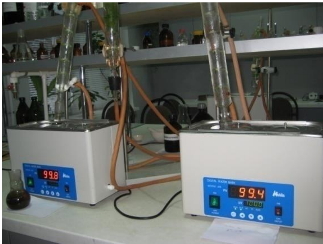
Fig. A 8.1. Obținerea extractelor hidro-alcoolice pe baia de aburi
