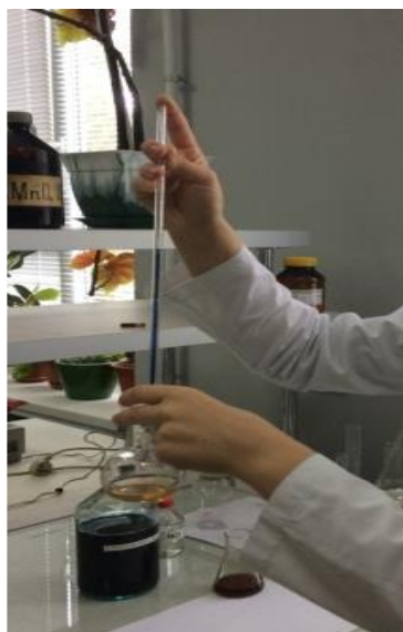
Fig. A. 8.19. Titrarea extractului cu 2,6-diclorfenolindofenolat de sodium până la culoarea roz persistent
