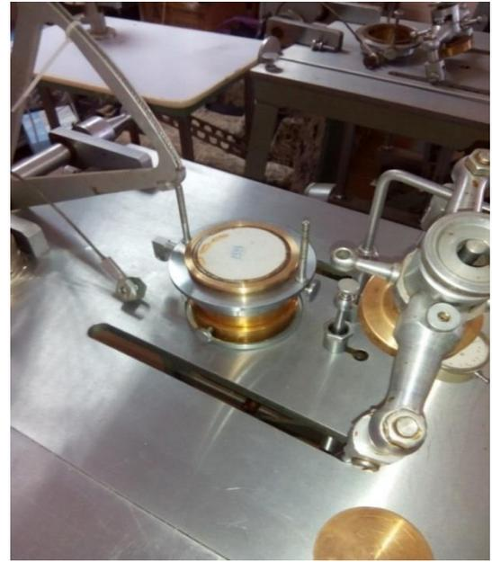
Рис. 2.12. Установка кольца с грунтом в верхнюю каретку сдвигового прибора
