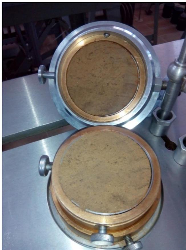
Рис. 2.16. Испытания на сдвиг по подготовленной поверхности.
