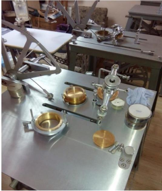
Рис. 2.11. Подготовка к испытаниям на сдвиговом приборе
