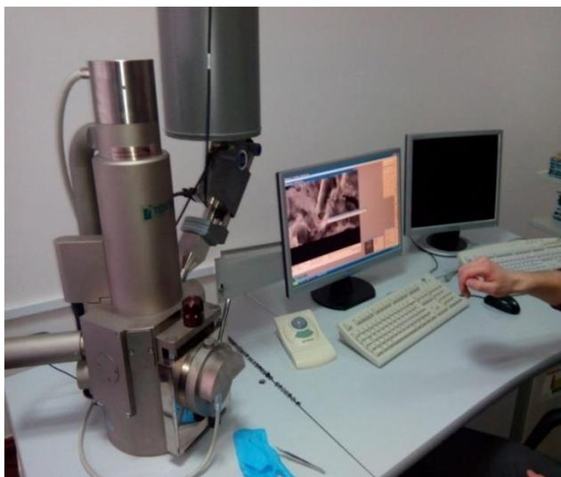
Рис. 3.11. Исследование микроструктуры с применением РЭМ
