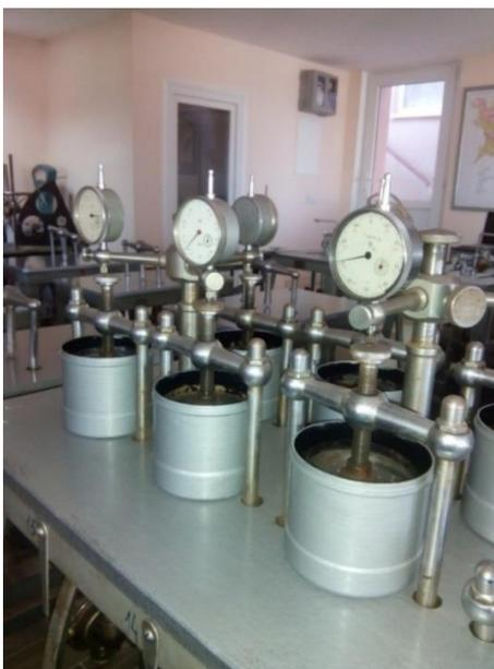
Рис. 3.8. Испытание на просадочность
