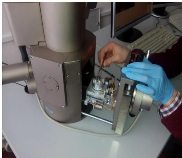
Рис. 3.12. Подготовка к испытаниям с применением РЭМ
