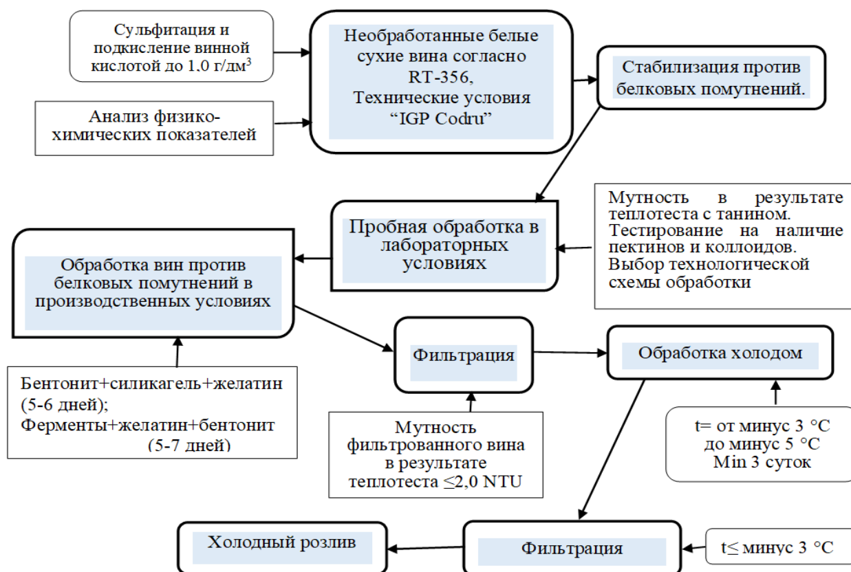
Рис.6. Усовершенствованная технологическая схема стабилизации белых сухих вин.
