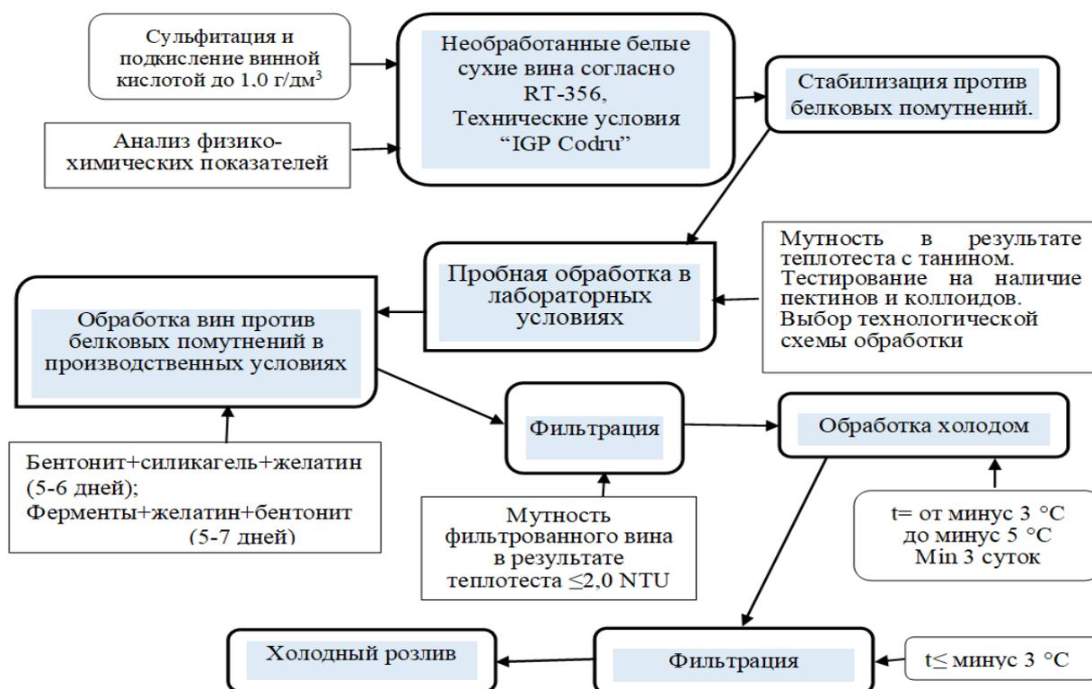
Рис. 4. 2. Усовершенствованная технологическая схема стабилизации белых сухих вин.
