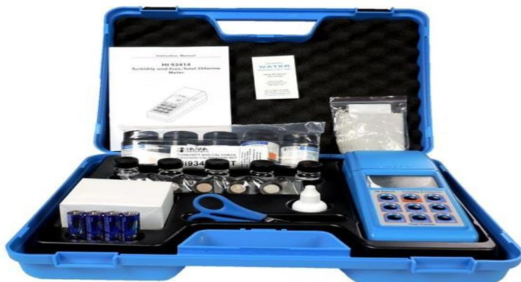
**Рис. 2.2. Портативный турбидиметр «HANNA» HI93414**
