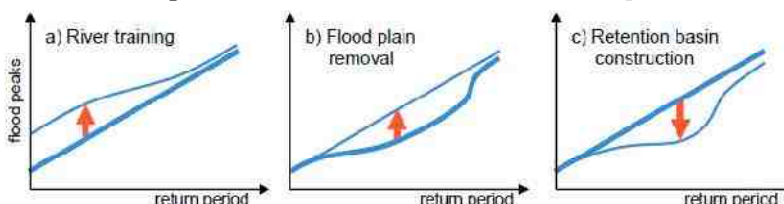
Fig. 1.5. Impactul ipotetic a trei tipuri de activități de inginerie hidraulică asupra curbei frecvenței debitelor maxime de viitură. (a) regularizarea râului (b) construirea digurilor de protecție (c) construirea bazinelor de retenție [tradus din 108, p. 2752].
