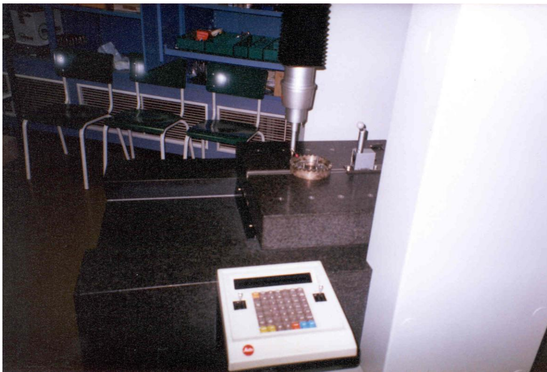
Fig. 5.5. Măsurarea roții dințate precesionale
