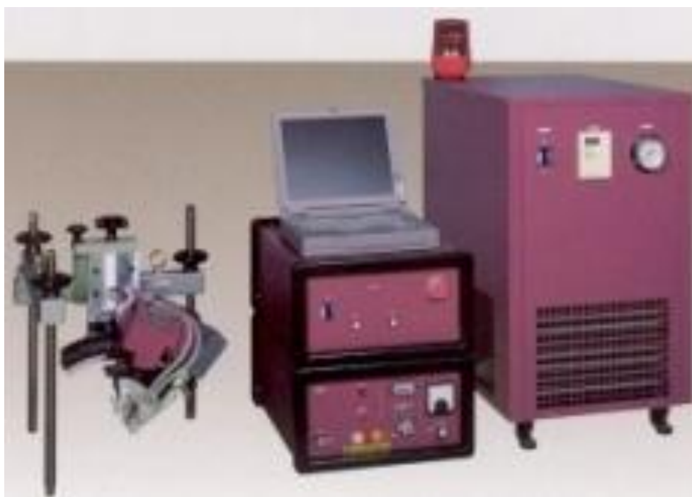
Fig. 5.3. Difractometrul MSF/PSF-3M pentru analiza tensiunilor remanente
