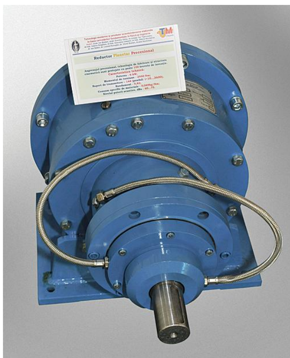
Fig. 6.41. Module electromecanice de acționare a aerliftului
