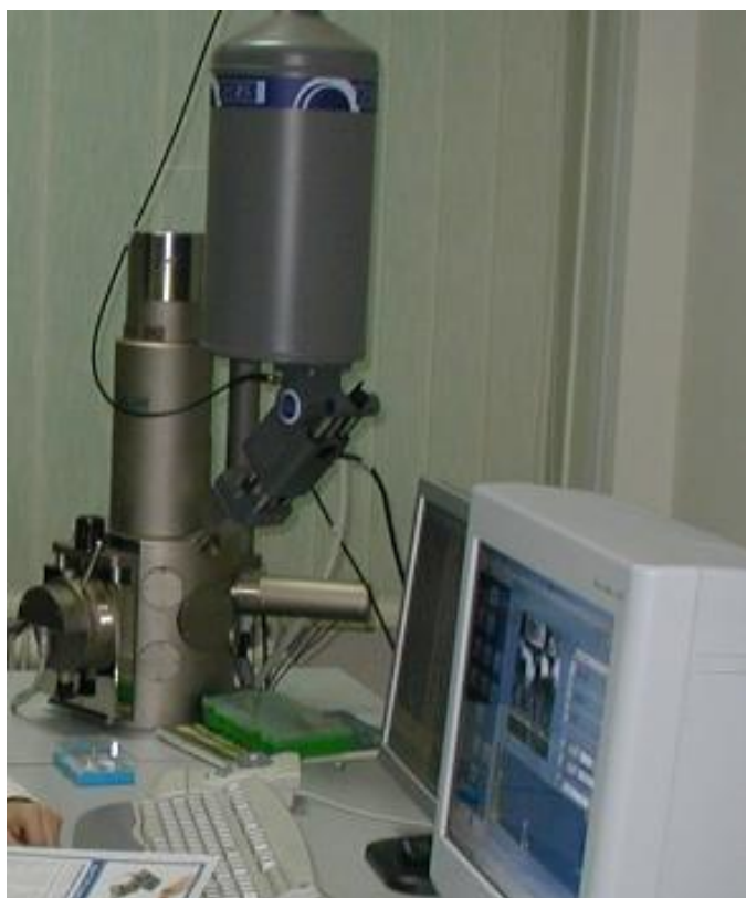
Fig. 5.2. Microscop electronic cu scanare VEGA TS 5130
