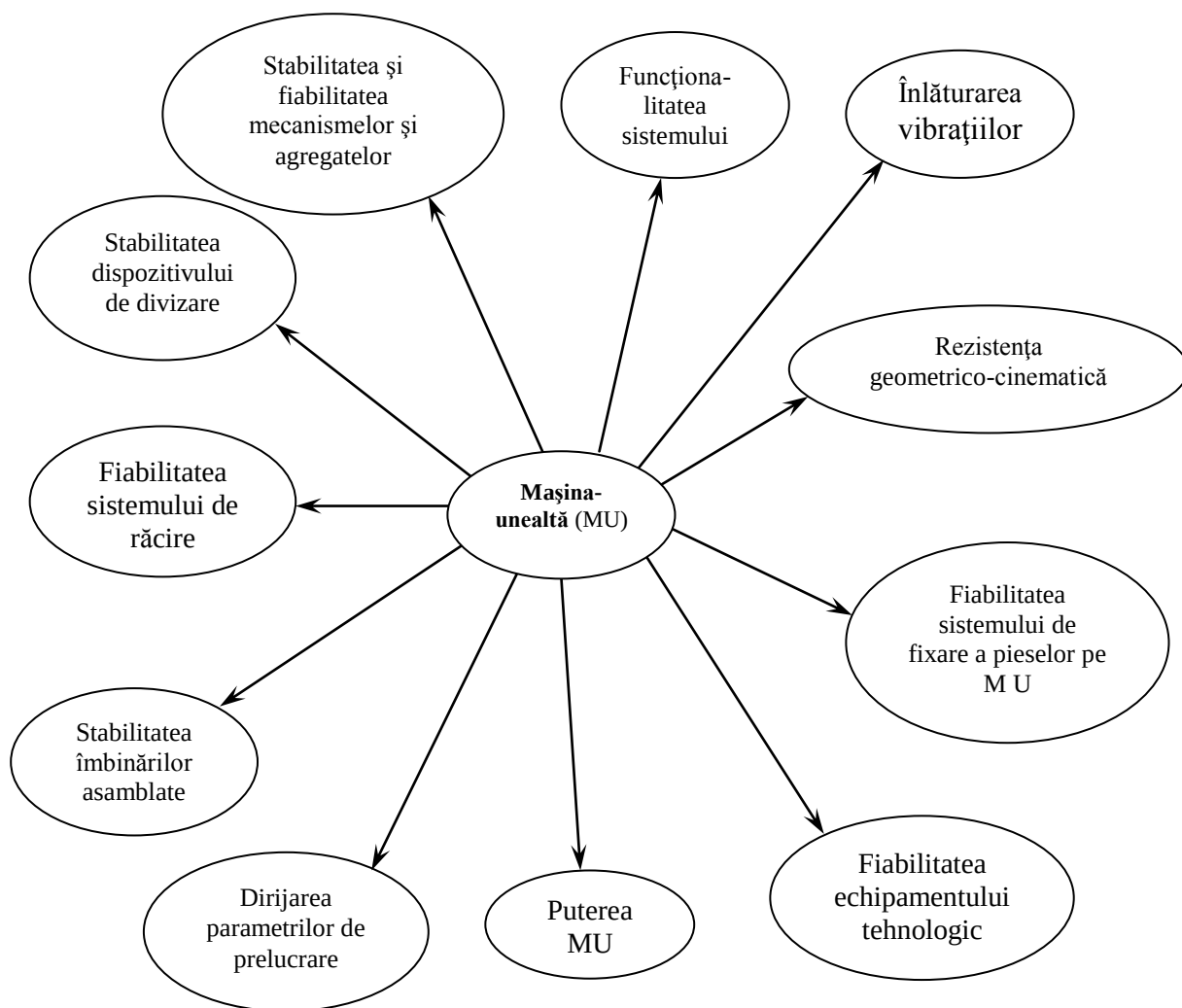
Fig. 1.8. Influența mașinii-unelte asupra formării stratului superficial
