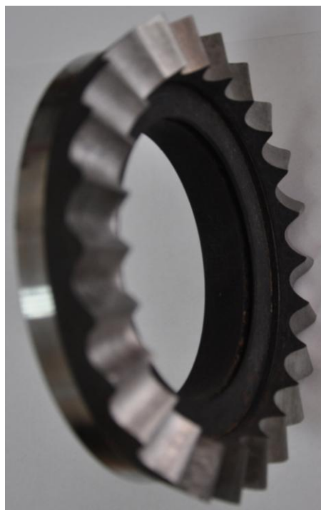
Fig. 5.1. Roată dințată precesională cu profil nestandardizat
