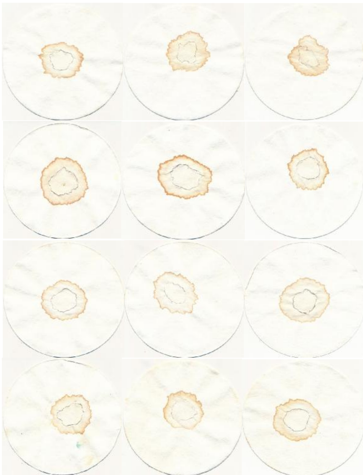
Фиг. 3.48. Определение влагоудерживающей способности мяса свиней по площади «влажного пятна»
