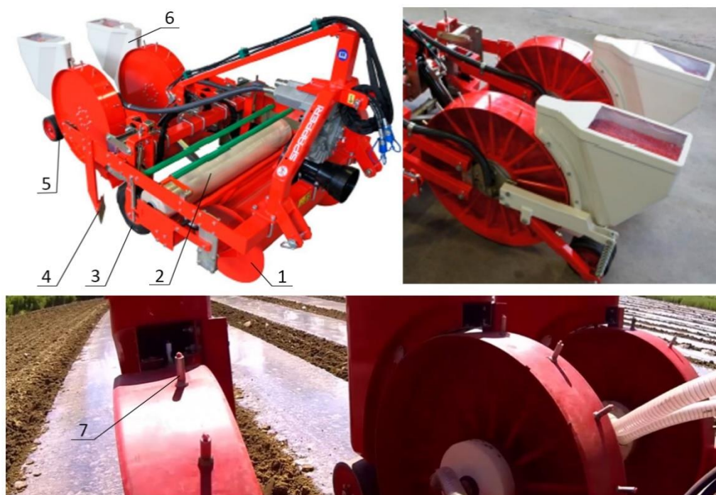
Fig. 1.6. Mașina combinată SMP cu semănătoare pneumatică a firmei italiene SPAPPERI [49]
