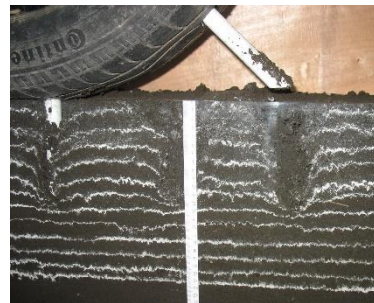
Fig. 4.5. Formarea profilului cuibului cu adâncimea de 12 cm
