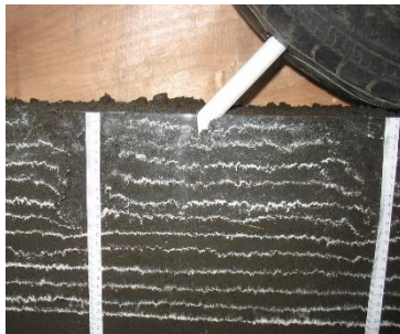
Fig. 4.5. Formarea profilului cuibului cu adâncimea de 12 cm
