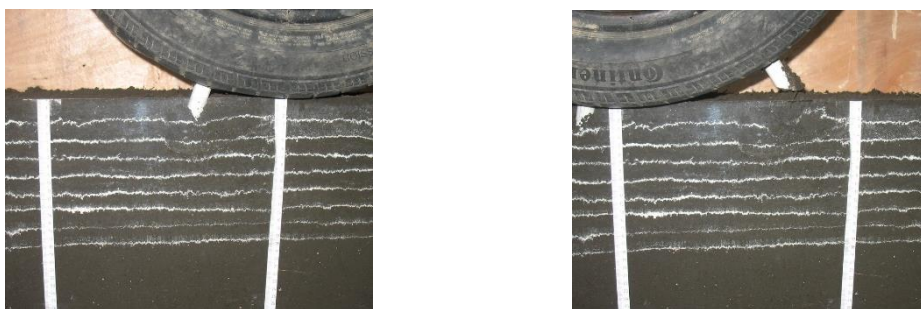
Fig. 4.1. Formarea profilului cuibului cu adâncimea de 4 cm
