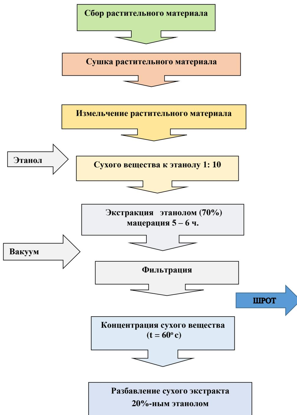
Рис. 3.11. Технологическая схема получения экстракта из корней *R. rhaponticum* L.
