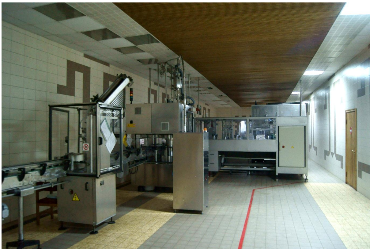
Figura A3.46. Secția de degorjare (foto V. Trifan, 2018)
