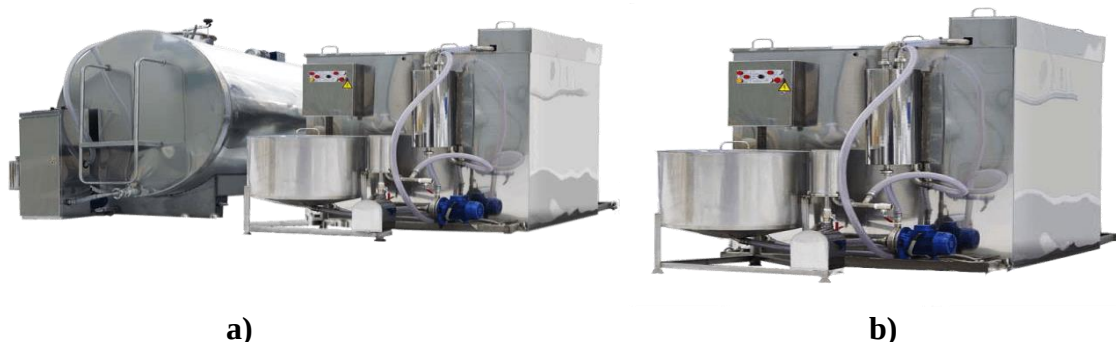
Fig. 1.6 a) Instalația pentru răcirea instantanee a laptelui cu vasul de răcire b) Instalația pentru răcirea instantanee a laptelui fără vasul de răcire [92].
