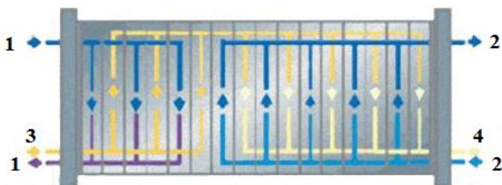
Figura A1.3. Fluxul de lapte și de apă în schimbătorul de căldură al răcitorului combinat de lapte[89].
