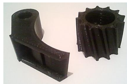
Fig. 13. Clapeta mobilă cu unghiul de lucru \delta_{ld} = 8° și cilindru canelat cu canelurile efectuate sub unghi de răsucire a cilindrului \alpha_{rc} = 22°
