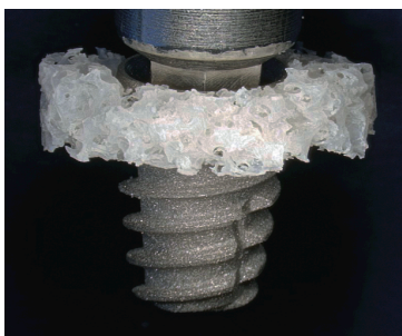
Fig. 2.10. Implantul bifazic constând din matrice osoasă demineralizată și implant propriu
