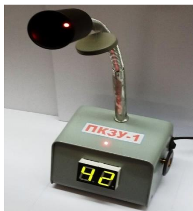
Рис.2.2. Внешний вид электронного прибора ПКЗУ-1, диагностирующего функциональность зрительного анализатора и двигательную утомляемость у теннисистов
