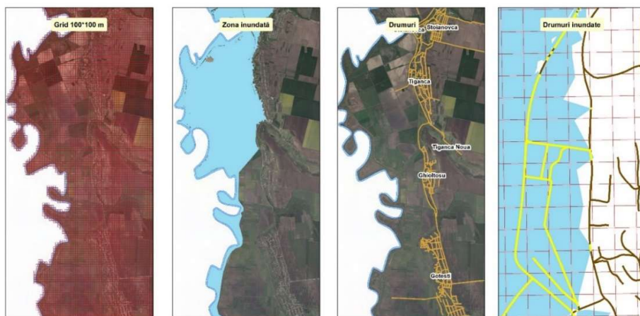
Figura 6. Metoda de calcul a lungimii elementelor – cheie de infrastructură (căi rutiere), zona pilot Gotești, r-nul Cantemir
