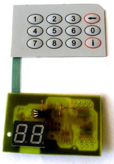
Рис.5.18. Физическая реализация электронного модуля для выбора угла фазового сдвига
