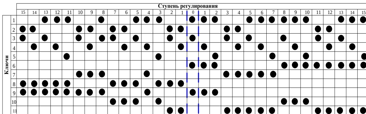
Рис.3.8. Закон управления силовыми ключами
