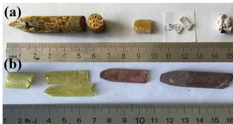
Figura 1. Lingou de Ga_2S_3 policristalin, monocristalul Ga_2S_3 crescut prin metoda Bridgman, prin transport în atmosferă de I_2 (CVD) și materialul compozit Ga_2O_3 - Ga_2S_3 obținut la temperatura de călire a cristalelor de Ga_2S_3 de 1173 K timp de 6 ore (a). Lingouri de policristal GaS , monocristal GaS , monocristal GaSe , monocristal GaSe intercalat cu Zn (b).
