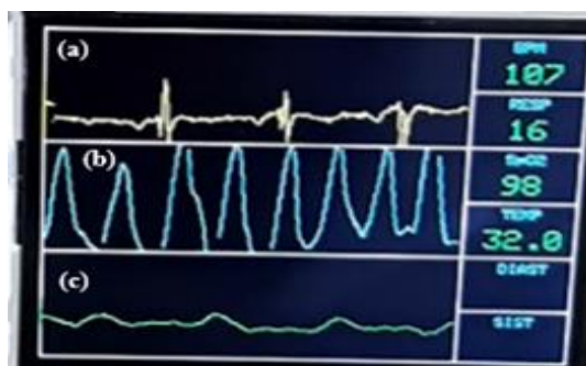
Figura 3.5. Pneumograma prelevată prin măsurarea impedanței (a) - semnalul ECG, (b) - pneumograma, (c) - fotopletismograma
