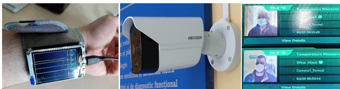
Fig. 3.8. Preluarea temperaturii corpului cu ajutorul prototipului și al camerei termale (a) - determinarea temperaturii cu ajutorul prototipului, (b) - camera termală Hikvision, (c) - afișarea rezultatului măsurării cu ajutorul camerei termale
