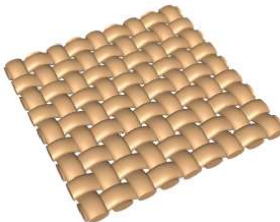
Figura 7. Reprezentare grafică a căptușelii – legătura pânză Simulare în program TexGen
