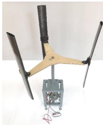
Fig. 4. Modelul experimental al turbinei eoliene cu ax vertical
