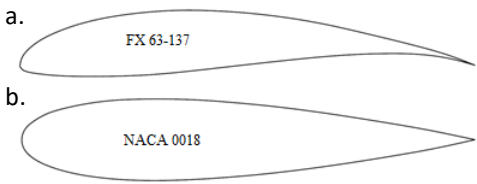
Fig. 7. Profilurile aerodinamice FX 63-137 (a) și NACA 0018 (b)
