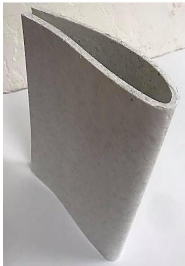
Fig. 22. Segment de pală închis din material plastic HDPE
