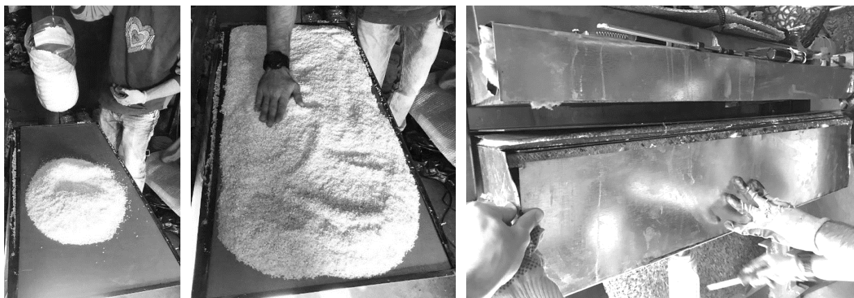
Fig. 3.14. Granule din plastic așezate pe masa de presat și presarea la cald
