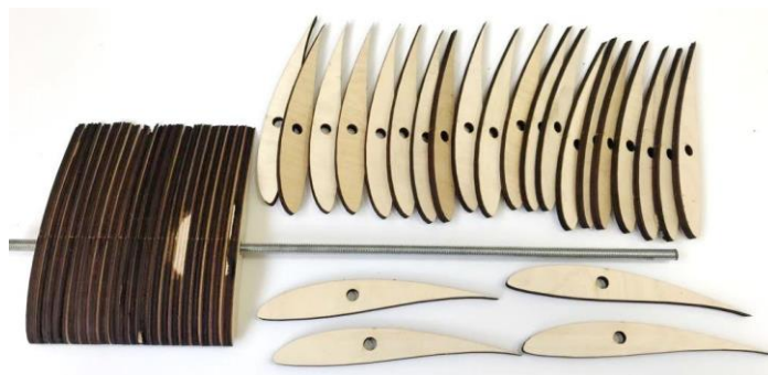
Fig. 3.9. Segmente de pală obținute prin tăiere cu laser
