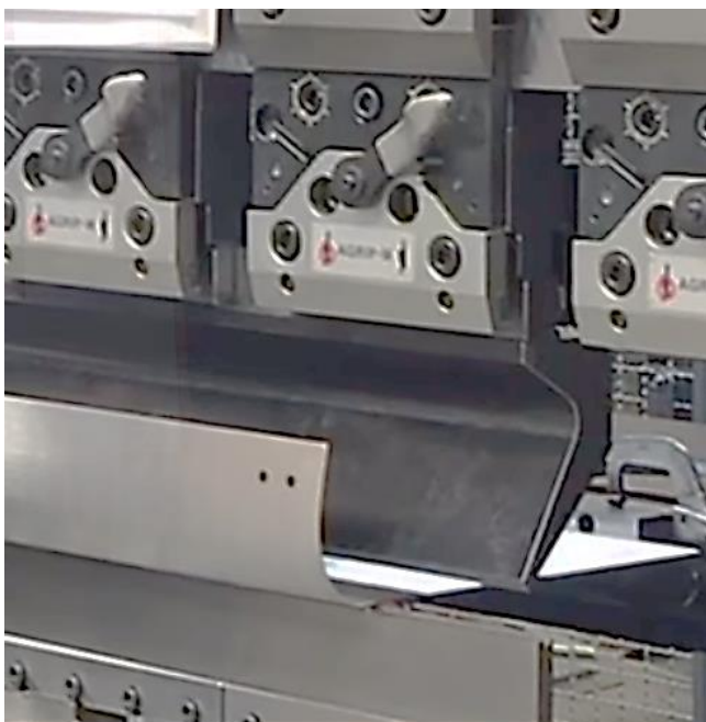
Fig. 1.30. Îndoirea tablei cu grosimea > 1 mm [96]
