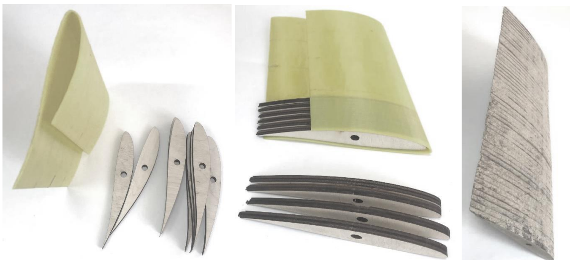
Fig. 3.12. Miezul matriței realizat din elemente tăiate cu laser din placaj
