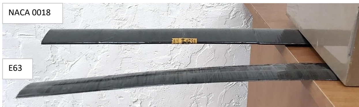
Fig. 2.68. Test care indică comparativ gradul de rigiditate a palelor, profil NACA 0018 și E63, fabricate din plastic tip PLA
