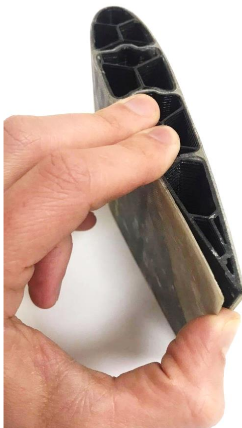
Fig. 3.25. Desprinderea materialului compozit de segmental de pală imprimat cu plastic PLA
