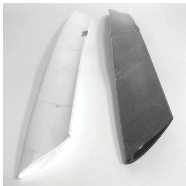
Fig. 2.33. Pale elicoidale profil FX 63-137 curbura exterior, versiunile închisă și cu deschidere interior
