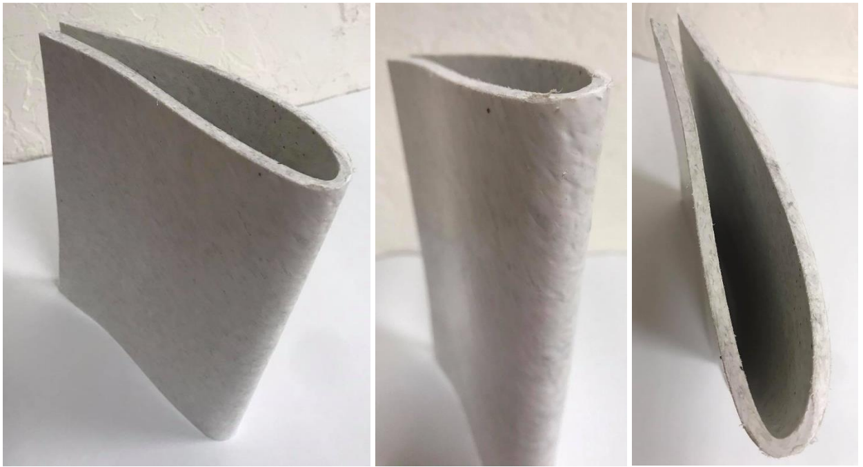
Fig. 3.16. Segmentul de pală închis din plastic, neregularitățile de la bordul de fugă și lipsa de pori interni pe suprafața tăiată a palei
