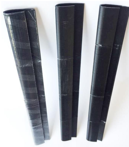
Fig. 2.25. Pale imprimate NACA 0018 drepte cu deschidere
