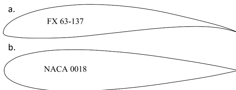
Fig. 2.18. Profilurile aerodinamice FX 63-137 (a) și NACA 0018 (b)
