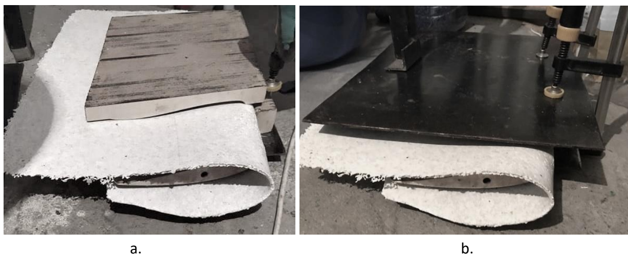
Fig. 3.15. Instalarea foii din plastic în matriță (a) și presarea la rece (b)
