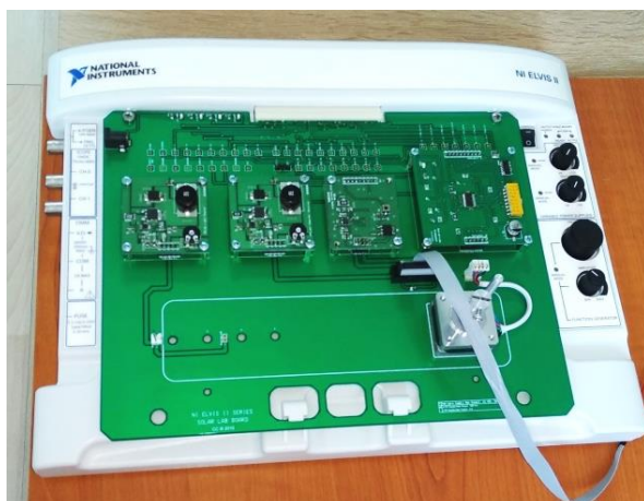
Fig. 2.9. Sistemul de achiziționarea a datelor NI Elvis II cu modulul RELab
