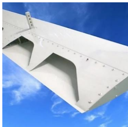
Fig. 1.29. Pală obținută prin îndoire din foaie de aluminiu [95]
