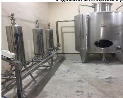
Fig.A.1.2. Instalația de filtrare prin membrane
