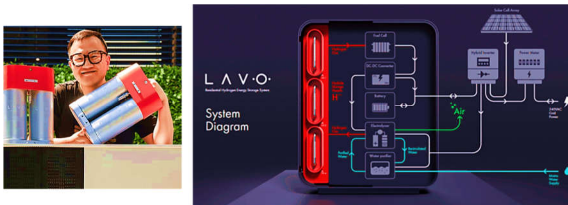
Figura A1.12. Sistemul integrat LAVO: producere și stocare hidrogen, generare energie electrică și termică cu o celulă cu combustibil [272]
