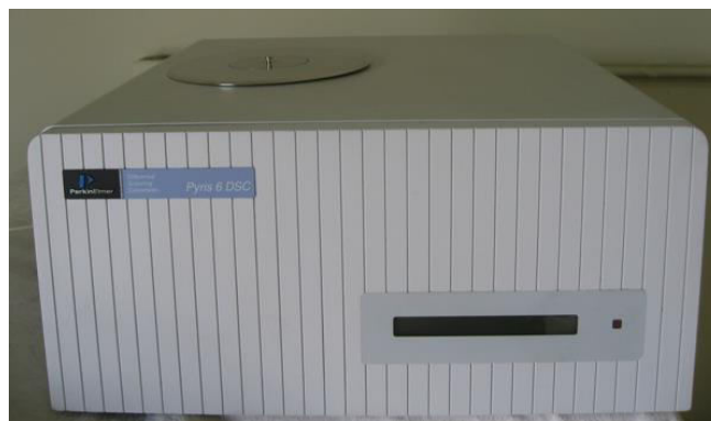
Fig. A 3.3 Aspectul exterior al calorimetrului cu scanare diferențială Pyris 6 (Pyris Series)
